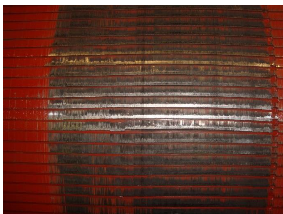
Danneggiamento superficiale della parte rotorica in seguito al guasto
